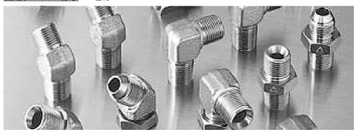
円錐形のねじで、先端に行くほど細くなります。規格番号はJIS B0203。水密性・気密性が高く、適正なトルクでねじ込むとがっちりと密着するため、水道管や真空配管 などの配管に使用されるものです。
